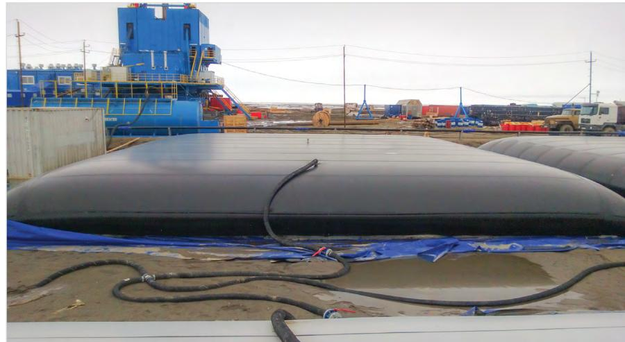
Рис. 1 – Нефтетанк объемом 100 м<sup>3</sup>
