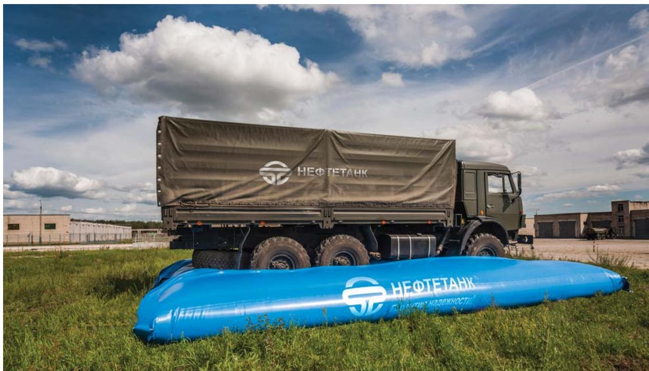
проведен ряд тестов — проезд настоящего танка по нефтетанку. Видео с этими испытаниями можно найти в сети Интернет либо запросить в офисе компании «Нефтетанк». Нефтетанк не только выдержал неоднократные проезды танка и другой спецтехники, но в настоящее время находится на складе компании «Нефтетанк» и готов к дальнейшей эксплуатации.
